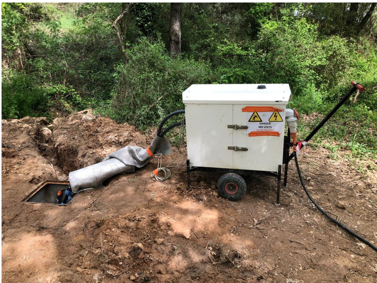
Figure 45 : Photo du module de test de réponse thermique, connecté à la sonde géothermique pilote
